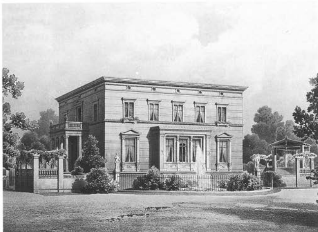
Entwurfszeichnung des Architekten Ferdinand von Arnim für seine Villa Weinbergstr./Ecke Schopenhauerstraße. Während der Eingang zur Villa (links im Bild) entlang der Weinbergstraße von einem Pergolengang gerahmt und gleichzeitig zum öffentlichen Straßenraum hin abgeschirmt wird, öffnet sich die Einfriedung zur Schopenhauerstraße in Form eines einfachen Stabzaunes für den Blick des Passanten. Ein Springbrunnen akzentuiert die Mittelachse der symmetrisch gegliederten Fassade. An der Grundstücksecke (rechts im Bild) bildet die Neu-gerde den Abschluss des Vorgartens. (aus Architektonisches Skizzenbuch Heft LIX Blatt 1)
